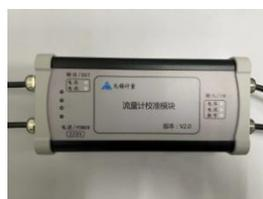
图 2-4 流量计修正模块
