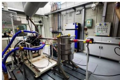
图 2-2 发动机测试台架
