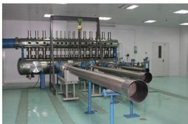
图 2-1 音速喷嘴气体流量标准装置
